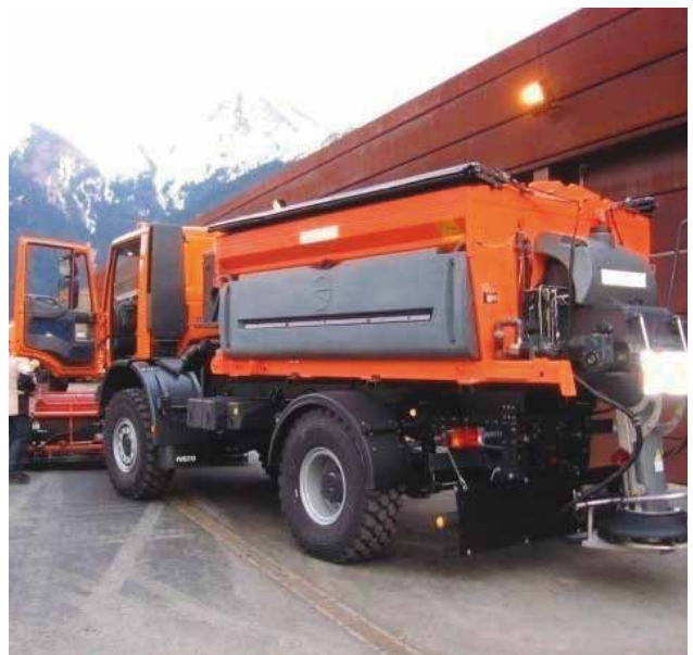
Esparcido homogéneo de fundente por centrifugación
