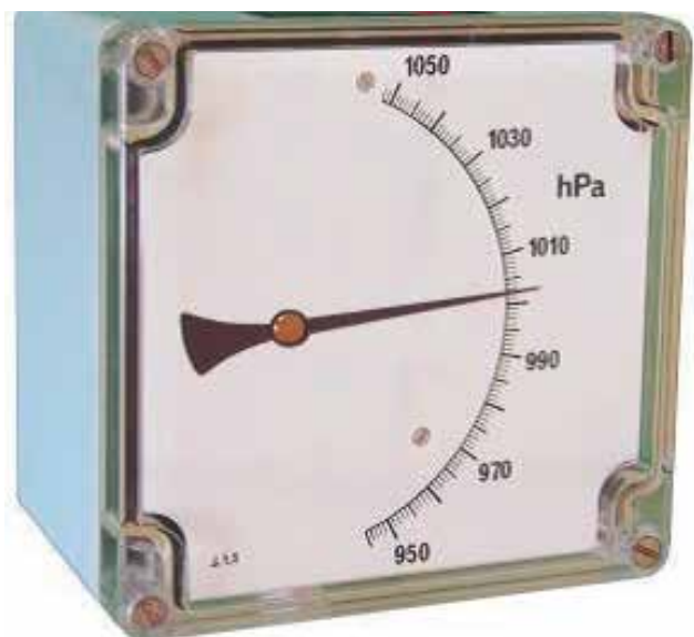
Sensor para medir la presión barométrica del aire
