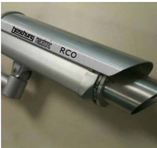
Sensor para medir la temperatura del aire y del pavimento, la lámina de agua, las condiciones de calzada (humedad, nieve, hielo, etc)
