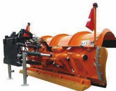
Sistema de flotación mediante soporte elástico
