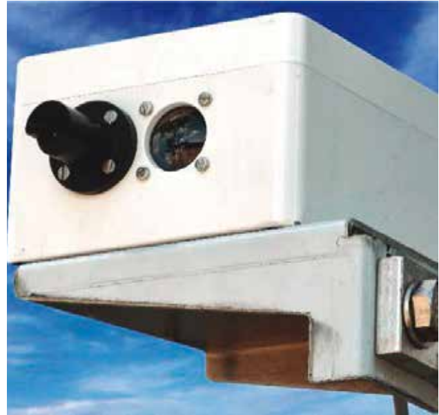
Sensor para medir el tipo, cantidad de precipitación y la visibilidad
